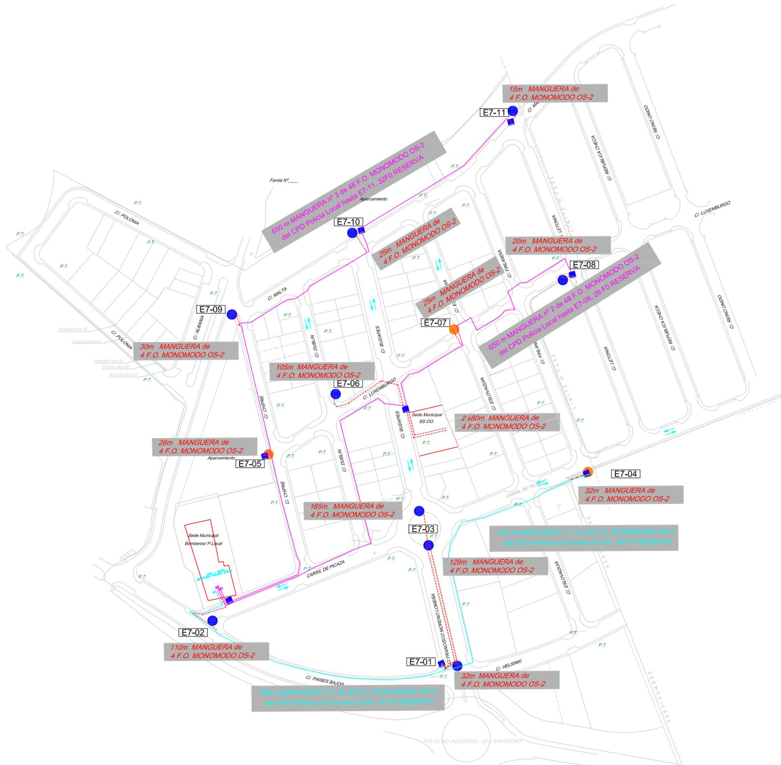
**RED DE FIBRA OPTICA DE LA FASE 4º DE LA INSTALACIÓN DEL SISTEMA DE VIDEO SENSORES PARA LA GESTIÓN Y CONTROL DEL TRÁFICO DE LA CIUDAD DE MARBELLA ZONA 7 : POLIGONO INDUSTRIAL SAN PEDRO ALCANTARA Y EL SALTO**
