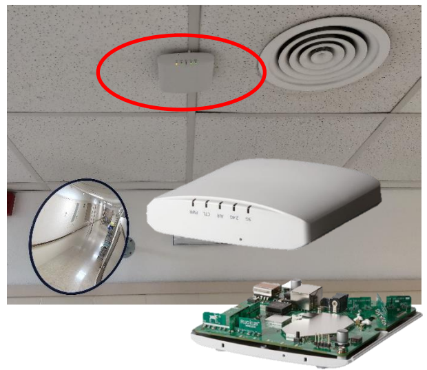
R320: Punto de acceso Wi-Fi 802.11ac 2x2:2 Wave 2 para interiores. Soporta hasta 256 clientes por AP.
